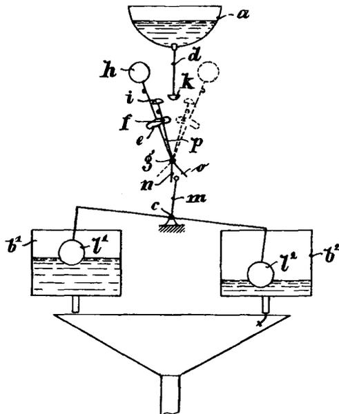
Zeiger m in pendelnde Bewegung setzen, wodurch die Gabel ngo abwechselnd nach rechts und nach links mitgenommen wird. Hierdurch wird das Kippgewicht h abwechselnd von links nach rechts bewegt, und der mitgenommene Stift p, der einen Kopf i trägt, veranlaßt, in regelmäßigen Zwischenräumen die Ventilstange d bei k für kurze Zeit anzuheben und den Auslauf der Zusatzflüssigkeit zu gestatten.
